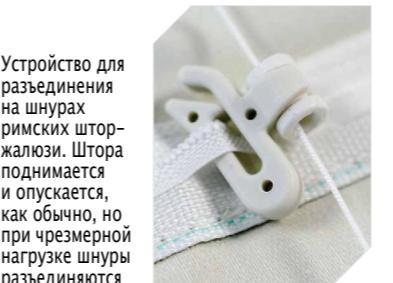
Устройство для разъединения на шнурах римских штор-жалюзи. Штора поднимается и опускается, как обычно, но при чрезмерной нагрузке шнуры разъединяются
