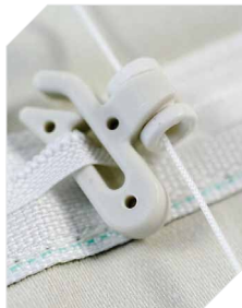
Megszakító szerkezet római roló zsinórján. A redőny normálisan fel- vagy leengedhető, de a zsinór túlzott terheléskor szétválék
